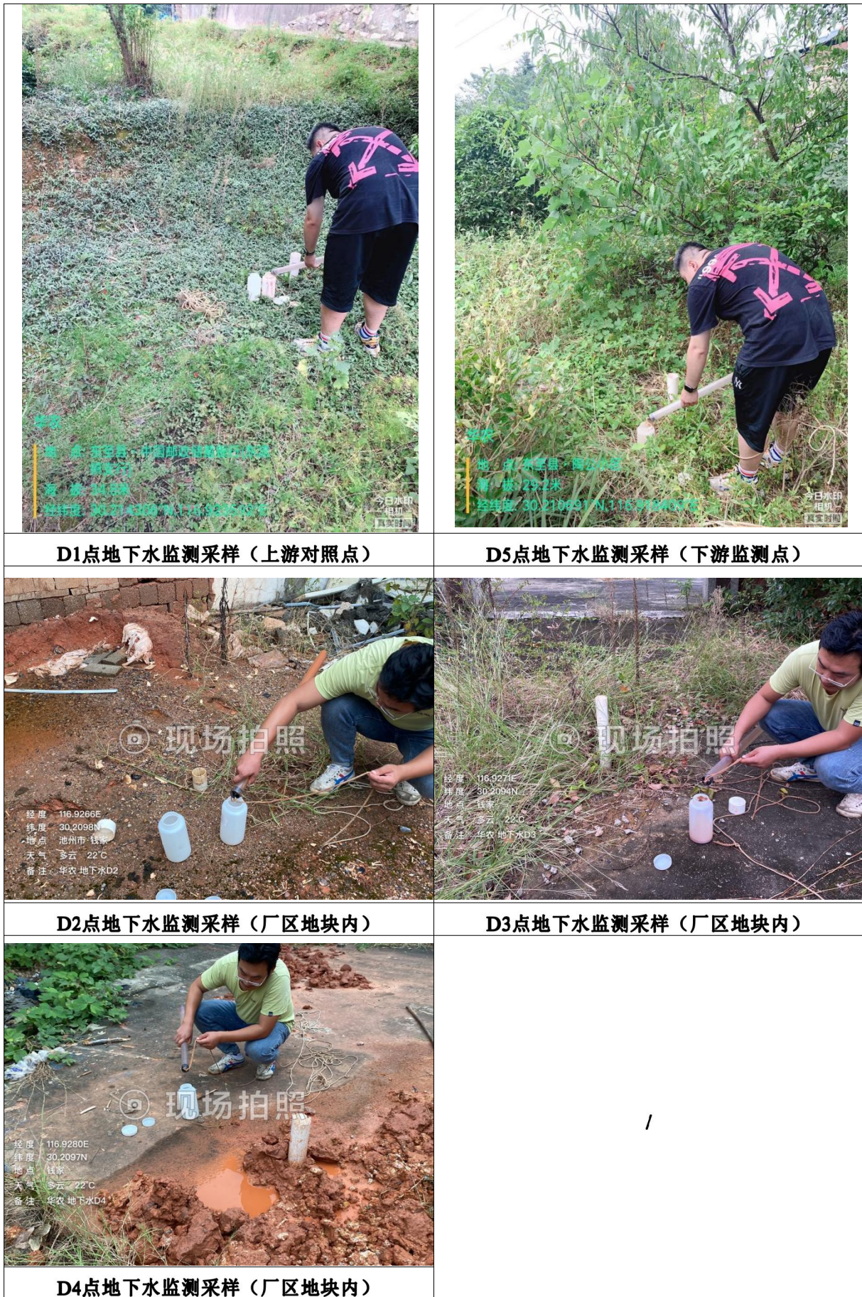
图5-1 地下水井建井及采样现场图
